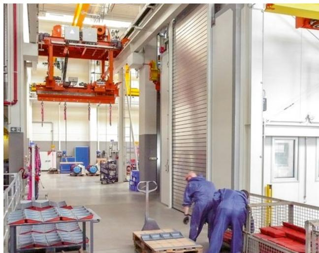
Aufgabe und Abnahme der Teile an das Schwerlastfördersystem erfolgt mit einem Querverschiebefahrwerk.
