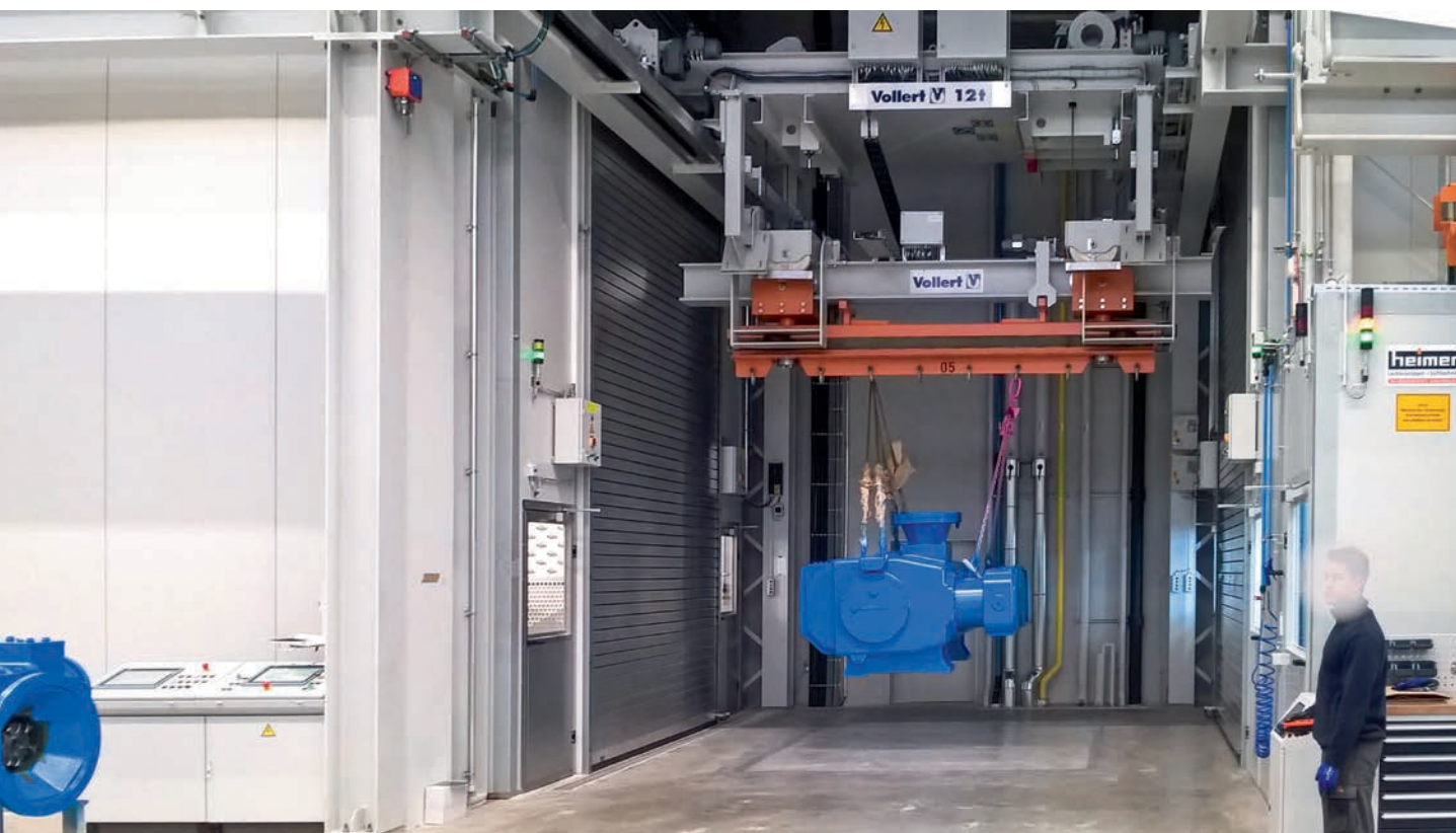
Das am Schwerlastfördersystem hängende Bauteil wird für eine zweite Beschichtung erneut in die Lackierkabine eingefahren.
