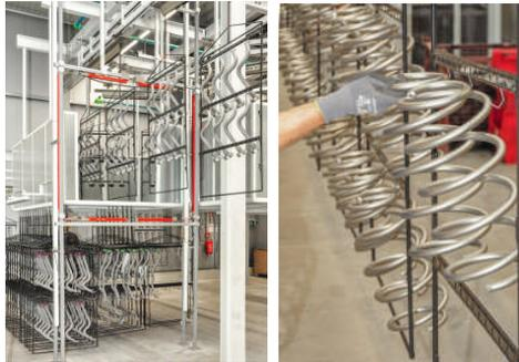
Abb. 1 und 2 zeigen einen Teil der zu beschichtenden Produkte, links Stabilisatoren, rechts Federelemente
