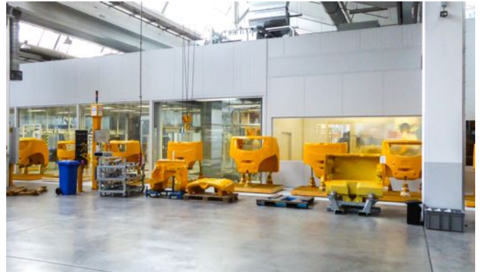
Abb. 6 Fertig beschichtete Bauteile im Abnahmebereich
