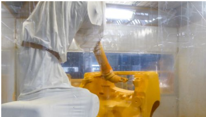
Abb. 4 Blick in die mit Schutzfolie verkleidete Lackierkabine
