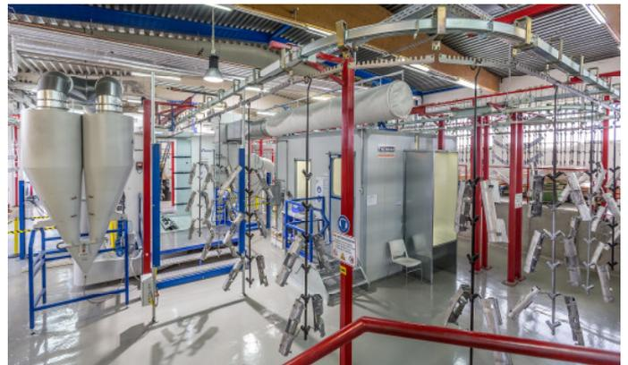
Abb. 3 Blick auf den Pulverkabinenbereich, links im Bild die Automatikkabine, rechts steht die Handkabine
