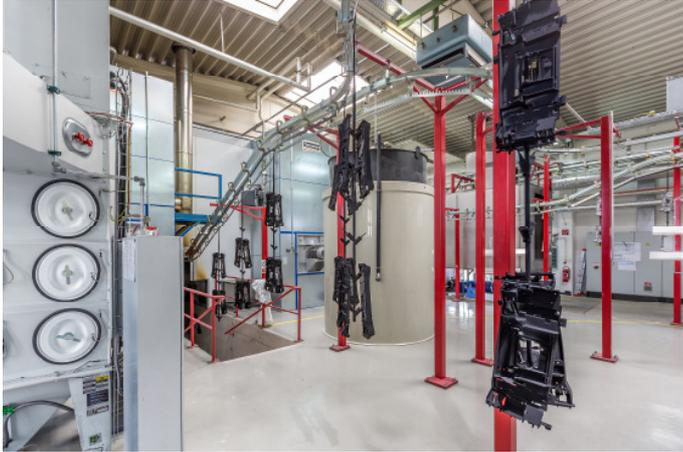
Abb. 7 Bahnführung zur A-Schleuse am Pulvereinbrennofen
