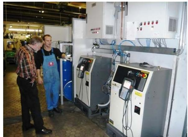
*Steuerschranke mit Teach-Panel für Roboter und Pistolen*
