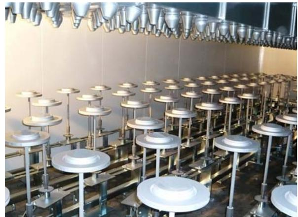
*Duplex-Bodenförderer mit Werkstücken im Trockner*
