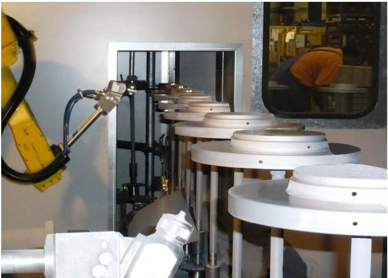
*Line-Tracking macht's möglich: stationäre Roboter beim Lackieren am laufenden Förderer*
