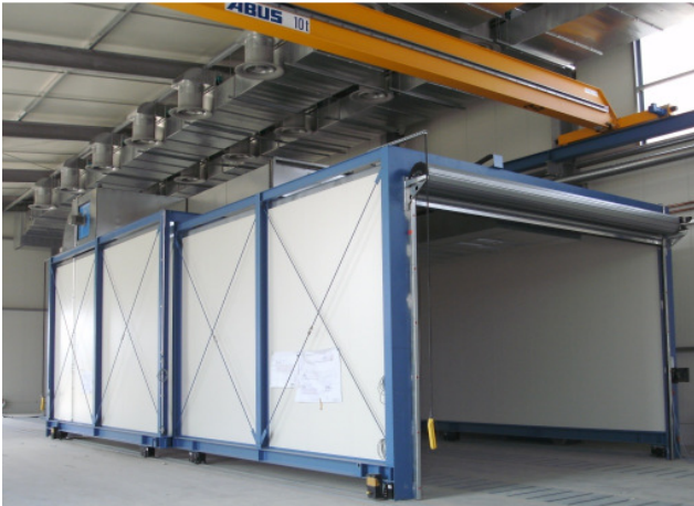
Abb. 4 Verfahrtdrockner mit obenliegendem Umluftgerät
